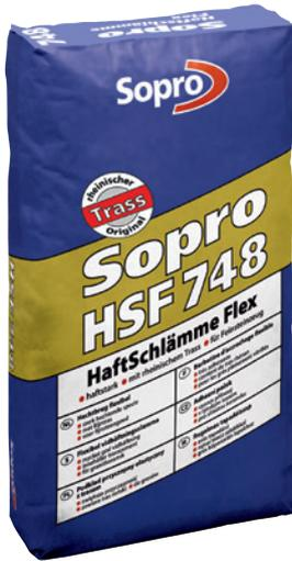
Einkomponentige, hochkunststoffvergütete, trasshaltige Haft- und Kontaktschlämme für die Verlegung von keramischen Fliesen und Platten, Beton- und Naturwerksteinen sowie Pflastersteinen. Chromatarm gemäß Verordnung (EG) Nr. 1907/2006, Anhang XVII.
