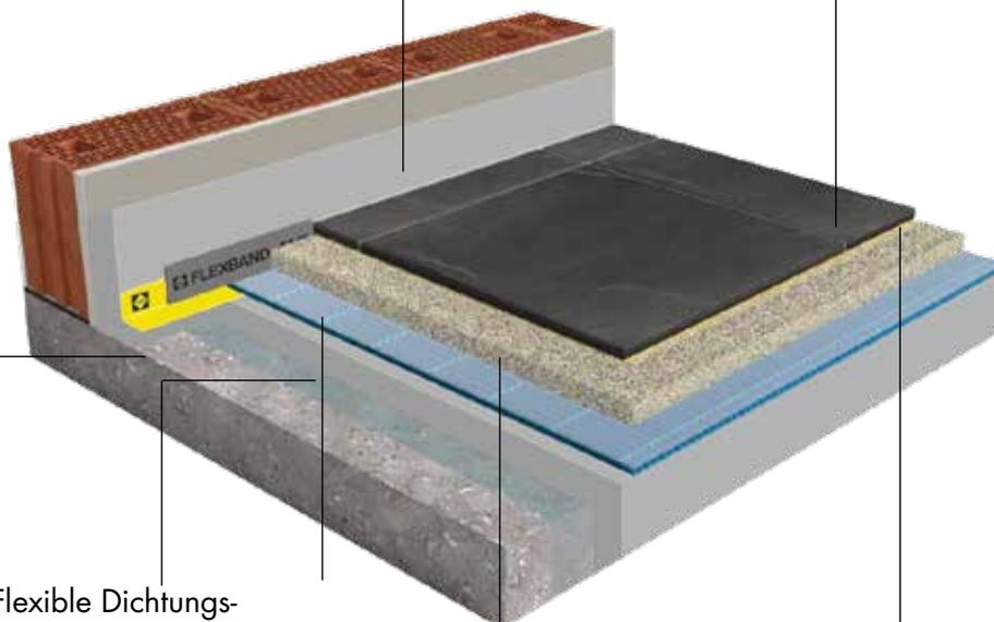
Flexible Dichtungsschlämme FDS
