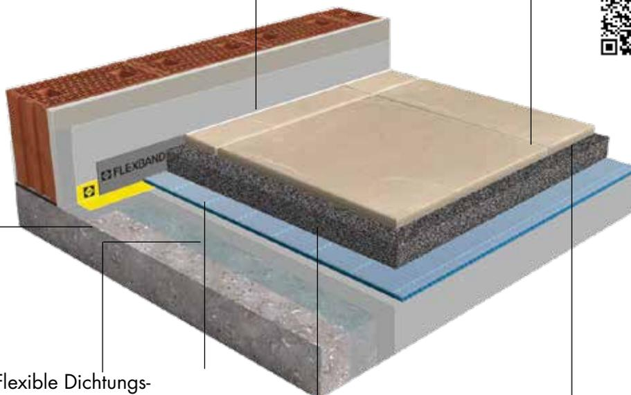
Flexible Dichtungsschlämme FDS
